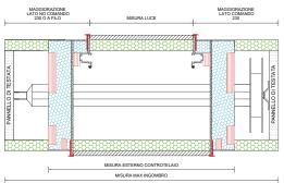
Monoblocco composto da CONTROTELAIO IN LEGNO OSB + SPALLA COIBENTATA IN XPS DA 40/60 E FIBROCEMENTO DA 5 mm con spessore in legno per fissaggio guida tapparella, assemblato con CASSONETTO COIBENTATO IN POLISTIRENE LINEA PLUS.
