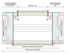
Monoblocco composto da CONTROTELAIO IN LEGNO OSB + SPALLA COIBENTATA IN XPS DA 40/60 E FIBROCEMENTO DA 5 mm con spessore in legno per fissaggio guida tapparella, assemblato con CASSONETTO COIBENTATO IN POLISTIRENE LINEA PLUS.
