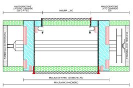
Monoblocco composto da CONTROTELAIO IN LEGNO MULTISTRATO FENOLICO + SPALLA COIBENTATA IN XPS E FIBROCEMENTO DA 5 mm assemblato con CASSONETTO COIBENTATO IN POLISTIRENE LINEA PLUS.
