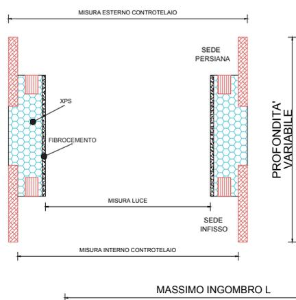
Monoblocco PER PERSIANA composto da **CONTROTELAIO IN OSB** assemblato con **SPALLA IN XPS DA 40/60 mm RIVESTITA CON FIBROCEMENTO DA 5 mm** "modello Ante Easy per persiana".
