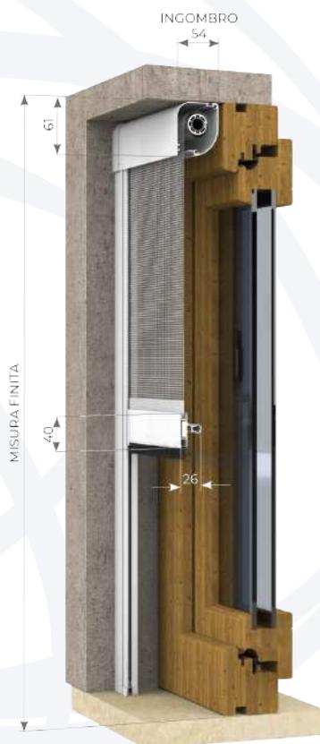
Le dimensioni della QUEEN 50 Catena devono essere trasmesse in mm indicando base per altezza, specificando se trattasi di misura finita o luce.
